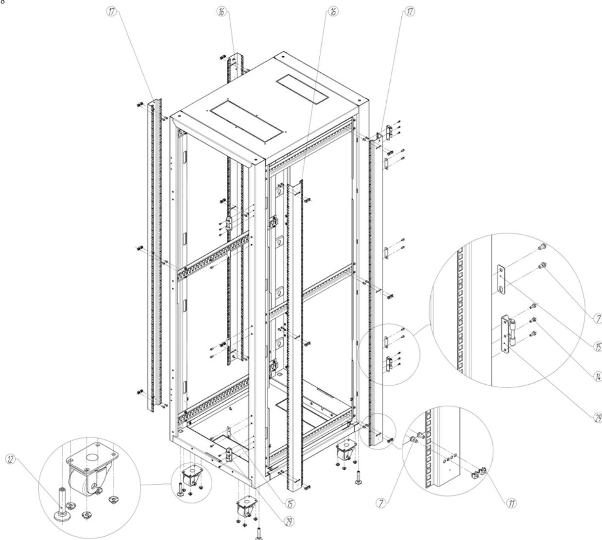
Установить в специальные места в нижней части рамок шарнирные регулируемые опоры (12). Установить в посадочные места ролики для транспортировки шкафа (в комплект поставки не входят, приобретаются опционально) в нижней части рамок, затянуть гайками шестигранными с фланцем.
