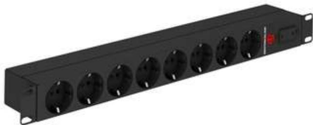
Блок силовых розеток NT SOC 230.16A1-8S-C20 представляет собой размещенные в металлическом корпусе: группу розеток типа Schuko (8 шт.) разъем IEC 320-C20 для присоединения шнура питания, автоматический выключатель 16А. Конструкция и размеры розетки, входящей в группу розеток соответствует требованиям ГОСТ 7396.2-91.(МЭК 884-2-1-87). Конструкция, габаритные и присоединительные (монтажные) размеры соответствуют требованиям ГОСТ Р 51322.1-2011(МЭК 60884-1-2006). Поставляется без шнура питания.
