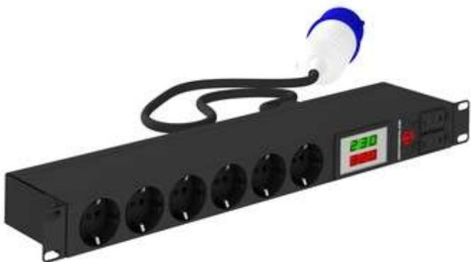
Блок силовых розеток NT SOC 230.32A2.VA-6S-IEC309 представляет собой размещенные в металлическом корпусе: группу розеток типа Schuko (6 шт.), кабель питания с разъемом IEC 309, автоматический выключатель 16А (2шт.) и вольт-амперметр. Конструкция и размеры розетки, входящей в группу розеток соответствует требованиям ГОСТ 7396.2-91.(МЭК 884-2-1-87). Конструкция, габаритные и присоединительные (монтажные) размеры соответствуют требованиям ГОСТ Р 51322.1-2011(МЭК 60884-1-2006).
