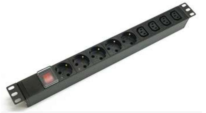
Блок силовых розеток NT SOC 230.10B-5S-4C13-C14 представляет собой размещенные в металлическом алюминиевом корпусе группу розеток типа Schuko (5 шт.) и IEC320 C13 (4 шт.), разъем IEC 320-C14 для присоединения шнура питания. Конструкция и размеры розетки, входящей в группу розеток соответствует требованиям ГОСТ 7396.2-91.(МЭК 884-2-1-87). Конструкция, габаритные и присоединительные (монтажные) размеры соответствуют требованиям ГОСТ Р 51322.1-2011 (МЭК 60884-1-2006).
