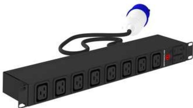
Блок силовых розеток NT SOC 230.32A2-8C19-IEC309 представляет собой размещенные в металлическом корпусе: группу разъемов IEC320-C19 (8 шт.), кабель питания 16А (2шт.). Конструкция и размеры розетки, входящей в группу розеток соответствует требованиям ГОСТ 7396.2-91.(МЭК 884-2-1-87). Конструкция, габаритные и присоединительные (монтажные) размеры соответствуют требованиям ГОСТ Р 51322.1-2011(МЭК 60884-1-2006).
