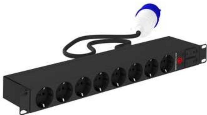
Блок силовых розеток NT SOC 230.32A2-8S-IEC309 представляет собой размещенные в металлическом корпусе: группу розеток типа Schuko (8 шт.), кабель питания с разъемом IEC 309, автоматический выключатель 16А (2шт.). Конструкция и размеры розетки, входящей в группу розеток соответствует требованиям ГОСТ 7396.2-91.(МЭК 884-2-1-87). Конструкция, габаритные и присоединительные (монтажные) размеры соответствуют требованиям ГОСТ Р 51322.1-2011 (МЭК 60884-1-2006).
