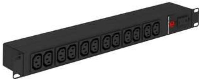
Блок силовых розеток NT SOC 230.16A1-12C13-C20 представляет собой размещенные в металлическом корпусе: разъемы IEC 320-C13 (12 шт.) разъем IEC 320-C20 для присоединения шнура питания, автоматический выключатель 16А.
