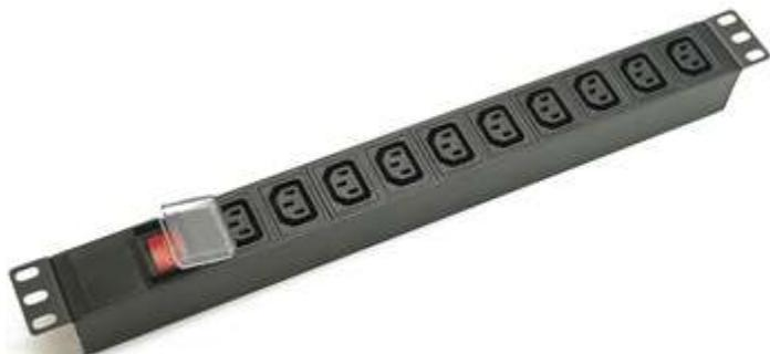
Блок силовых розеток NT SOC 230.10B-10C13-C14 представляет собой размещенные в металлическом алюминиевом корпусе группу розеток типа IEC 320-C13 (10 шт.), разъем IEC 320-C14 для присоединения шнура питания. Конструкция и размеры розетки, входящей в группу розеток соответствует требованиям ГОСТ 7396.2-91.(МЭК 884-2-1-87). Конструкция, габаритные и присоединительные (монтажные) размеры соответствуют требованиям ГОСТ Р 51322.1-2011 (МЭК 60884-1-2006).
