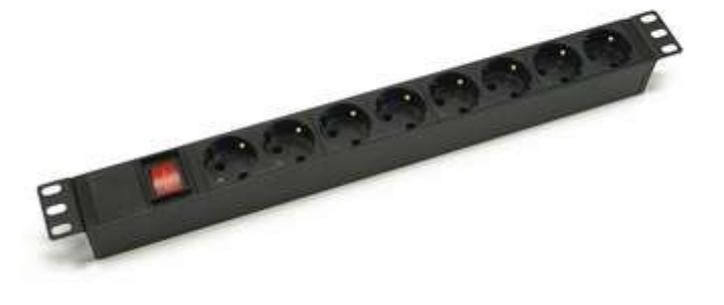
Блок силовых розеток NT SOC 230.10B-8S-C14 представляет собой размещенные в металлическом алюминиевом корпусе группу розеток типа Schuko (8 шт.), разъем IEC 320-C14 для присоединения шнура питания. Конструкция и размеры розетки, входящей в группу розеток соответствует требованиям ГОСТ 7396.2-91.(МЭК 884-2-1-87). Конструкция, габаритные и присоединительные (монтажные) размеры соответствуют требованиям ГОСТ Р 51322.1-2011 (МЭК 60884-1-2006).
