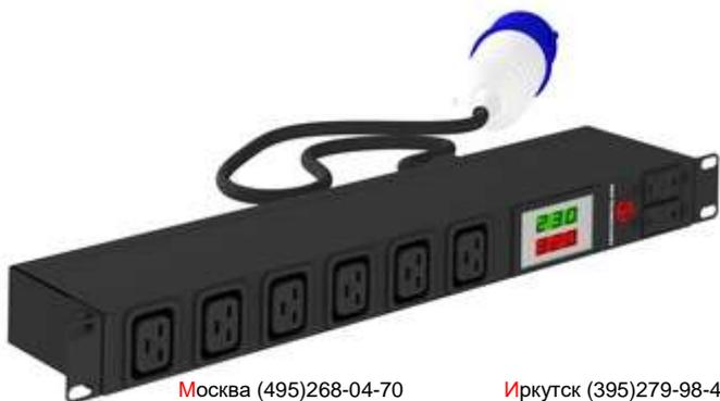
Блок силовых розеток NT SOC 230.32A2.VA-6C19-IEC309 представляет собой размещенные в металлическом корпусе: группу разъемов IEC320-C19 (6 шт.), кабель питания с разъемом IEC 309, автоматический выключатель 16А (2шт.) и вольт-амперметр. Конструкция и размеры розетки, входящей в группу розеток соответствует требованиям ГОСТ 7396.2-91.(МЭК 884-2-1-87). Конструкция, габаритные и присоединительные (монтажные) размеры соответствуют требованиям ГОСТ Р 51322.1-2011(МЭК 60884-1-2006).
