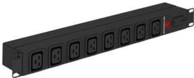
Блок силовых розеток NT SOC 230.16A1-8C19-C20 представляет собой размещенные в металлическом корпусе: разъемы IEC 320-C19 (8 шт.) разъем IEC 320-C20 для присоединения шнура питания, автоматический выключатель 16А.
