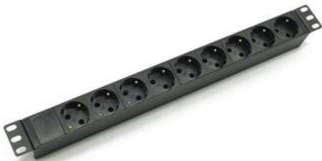
Блок силовых розеток NT SOC 230.10-9S-C14 представляет собой размещенные в металлическом алюминиевом корпусе группу розеток типа Schuko (9 шт.), разъем IEC 320-C14 для присоединения шнура питания. Конструкция и размеры розетки, входящей в группу розеток соответствует требованиям ГОСТ 7396.2-91.(МЭК 884-2-1-87). Конструкция, габаритные и присоединительные (монтажные) размеры соответствуют требованиям ГОСТ Р 51322.1-2011 (МЭК 60884-1-2006).
